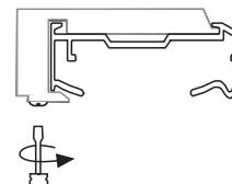
**EasyRise™:** Introduzca la parte trasera del cabezal en la lengüeta inferior del soporte. Presione la parte frontal del cabezal hacia atrás y arriba, hasta que haga "clic".
