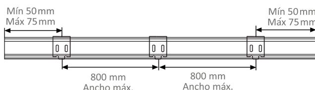
1. Marque la ubicación de los soportes a muro o a techo, perfectamente alineados y nivelados, con una separación máxima entre cada uno de 800 mm.
