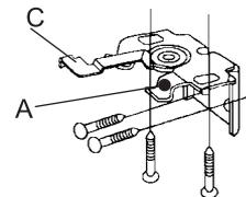
5.- Posicione el cabezal de su persiana e introduzca la lengüeta frontal (A) de los soportes de instalación, en la pestaña delantera del cabezal.
